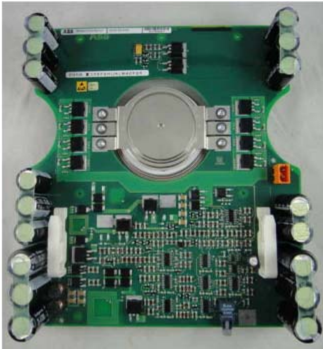
Рисунок 1.6 – Плата IGCT (замикного тиристора, інтегрованого із драйвером)
