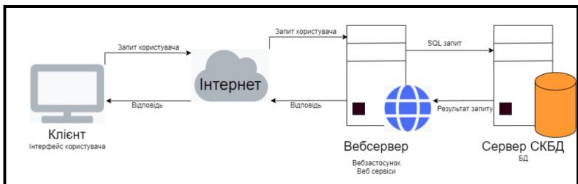
Рисунок 1.8 – Проста вебсистема клієнт-сервер
