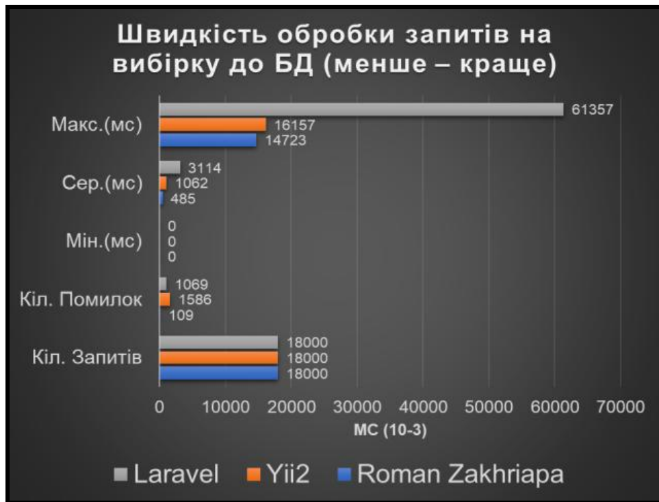
Рисунок 3.1 – Порівняння швидкості обробки запитів на вибірку до БД з використанням програми Apache JMeter
