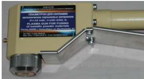
Рисунок 1.11- Комбінований плазмотрон для наплавлення
