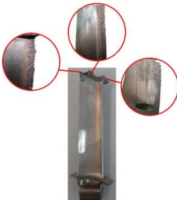
Рисунок 1.5 – Приклади зношування робочої лопатки
