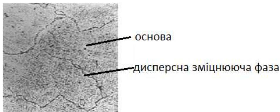
Рисунок 1.7 - Структура металу пера лопаток зі сплаву ЖС26-ВІ в початковому стані (x1000)
