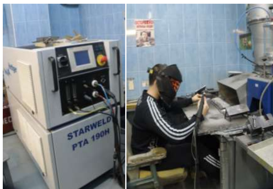
Рисунок 1.13 – Пост для ручного плазово-порошкового наплавлення
