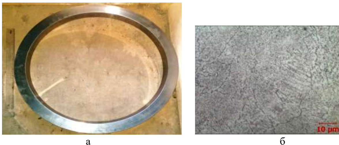
Рисунок 5.5 – Зовнішній вигляд (а) та мікроструктура (б) кільця зі сплаву ВЖ98, вирощеного адитивним мікроплазмовим наплавленням
