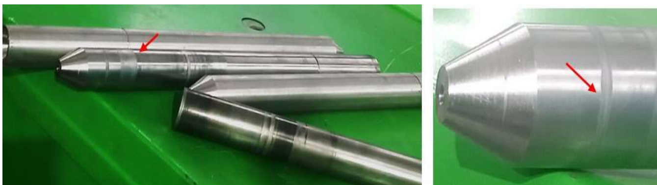
Рисунок 3.6 – Кільцева вибірка на поверхні заготовки, що розпилюється, від контакту із притискним роликом після роботи на установці УЦР-4 (до модернізації)
