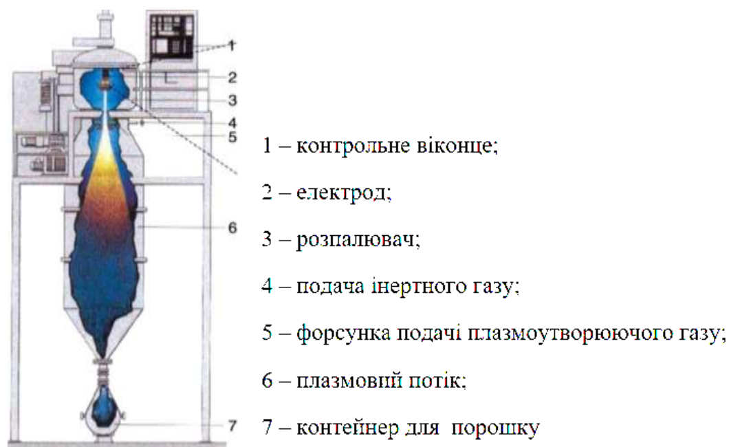
Рисунок 1.10 – Схема процесу розпилення в результаті індукційного нагріву [7]
