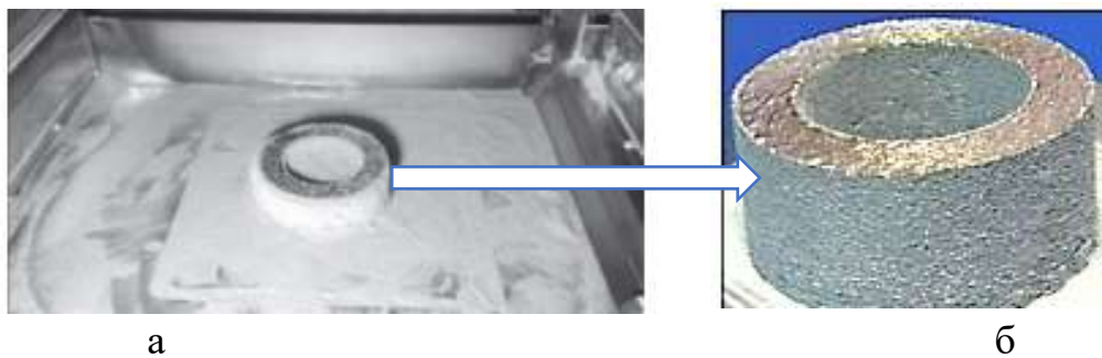
Рисунок 5.8 – Виріб у вакуумній камері 3D-принтера (а) та зовнішній вигляд виробу, отриманого електронно-променевим друком із застосуванням порошку сплаву Ti-6Al-4V
