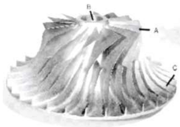
Рисунок 1.7 – Зовнішній вид ротору вертольота (Ti-6-4) безпілотника (UCAR), виготовлений лазерним 3D-друком [55]
