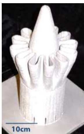
Рисунок 1.7 – Зовнішній вид ротору вертольота (Ti-6-4) безпілотника (UCAR), виготовлений лазерним 3D-друком [55]
