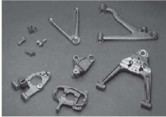
Рисунок 1.5 – Деталі, виготовлені методом рідко-твердого формування [21]
