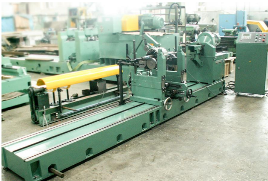
Рисунок 5.7 – Балансувальний верстат типу HL-100 фірми Hofmann
