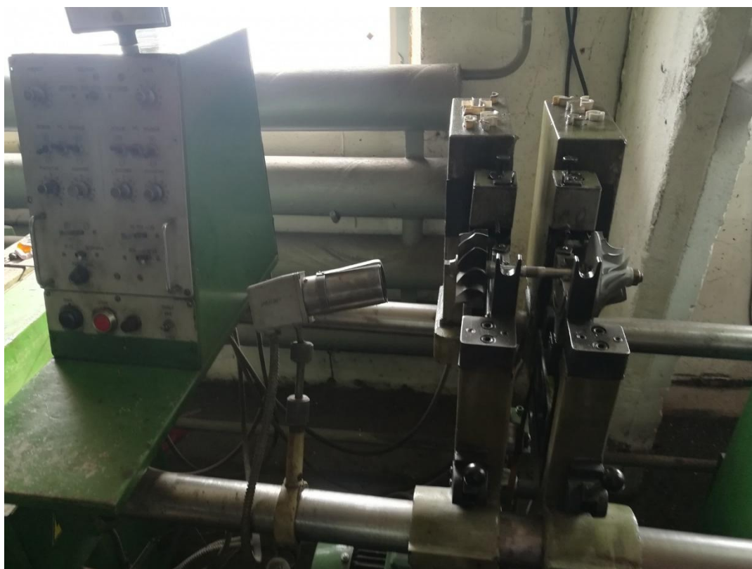
Рисунок 5.5 – Балансувальний верстат моделі ДБ-50
