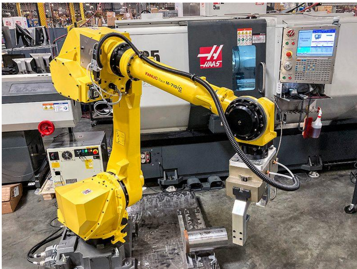
Рисунок 3.1 – Роботизований комплекс HaasRobotPackage 3
