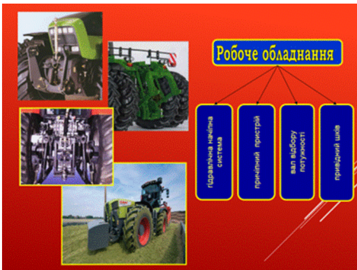
Рисунок 2.5 – Робоче обладнання трактора
