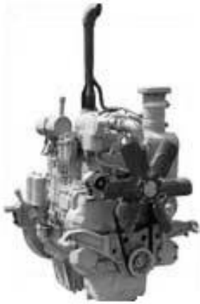
Рисунок Б.5 – Двигун типу Д 180: рядний, чотиритактний дизель, з турбонаддувом, багатопаливний
