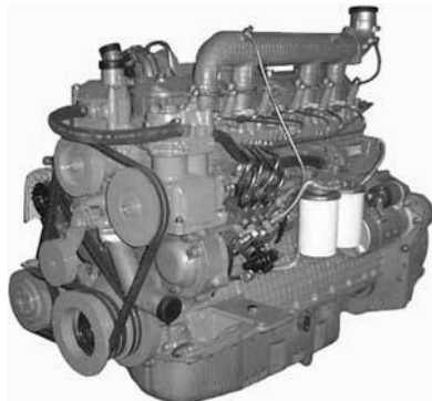
Рисунок Б.4 – Двигун Д-260.7С: шестициліндровий, рядний, чотири- тактний дизель, рідинного охолодження, з газотурбінним наддувом і проміжним охолодження наддувочного повітря
