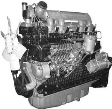
Рисунок Б.3 – Двигун Д-260.1: шестициліндровий, рядний, чотири- тактний дизель, рідинного охолодження, з газотурбінним наддувом
