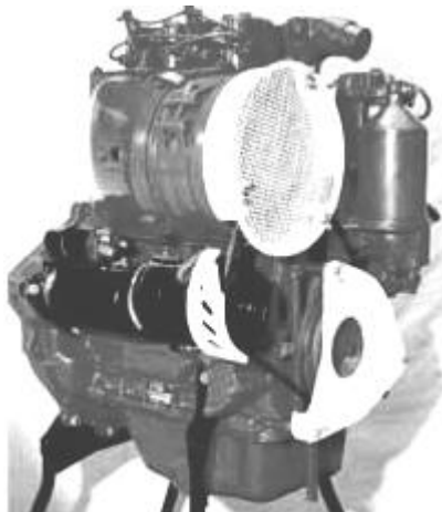
Рисунок Б.7 – Двигун Д120: чотиритактний, рядний, двоциліндровий дизельний двигун повітряного охолодження
