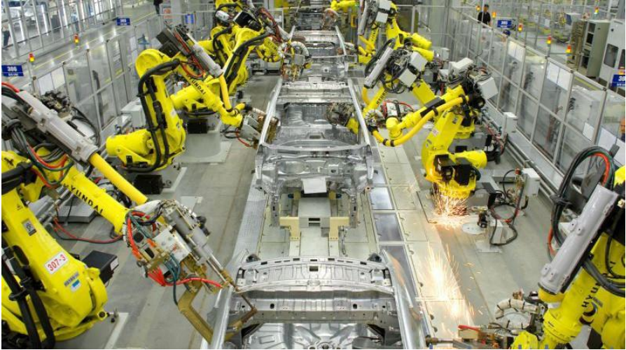
Рисунок 3.4 - Зварювальний цех по складанню автомобільних кузовів
