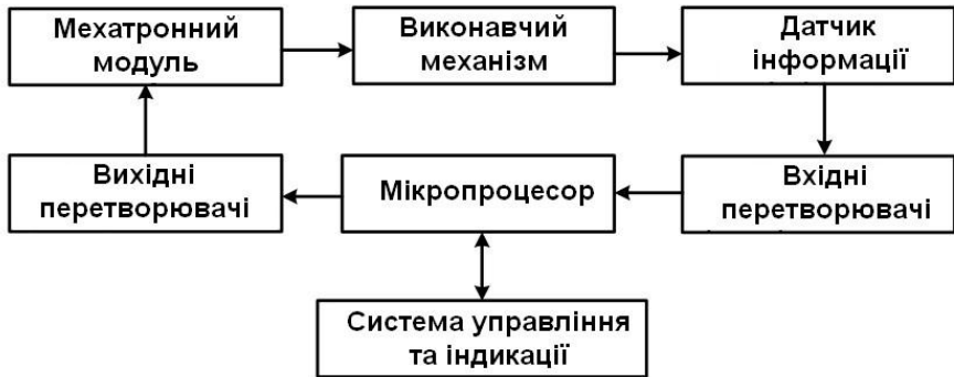
Рисунок 1.2 - Функціональна схема мехатронної системи
