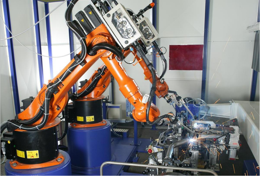
Рисунок 3.5 - Виконання роботом операції зварювання
