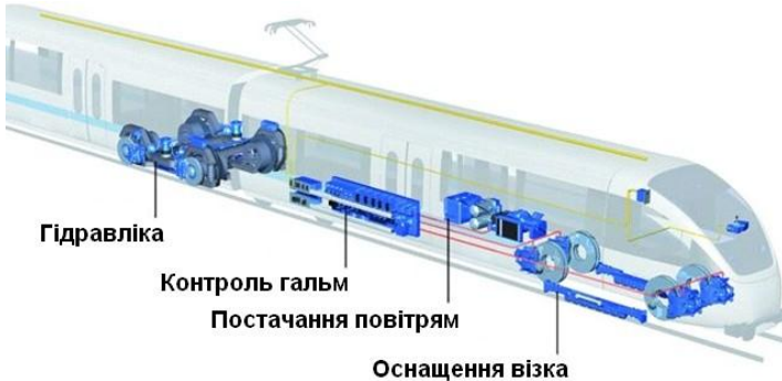
Рисунок 3.10 - Гальмова система поїзда
