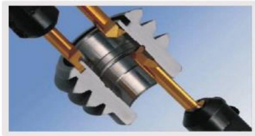
Рис. 1.2 - Мікрорезець для обробки малих отворів
