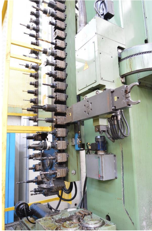
Рис. 2.9 – Ланцюговий автоматичний змінник інструменту з поворотним важелем і двома захопленнями, встановлений на фрезерному верстаті.
