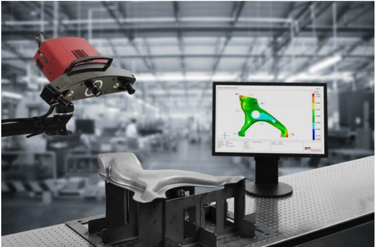
Рис. 1.9 – Приклад лазерного сканування деталі.
