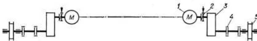
Рисунок 6.1 – Кінематична схема механізму пересування конвеєра
