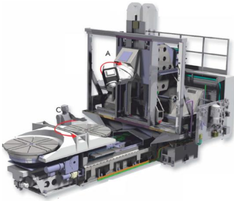
Рисунок 13.7 – Гнучка верстатна чарунка з верстатом HURON MX12 з пристроєм заміни піддонів
