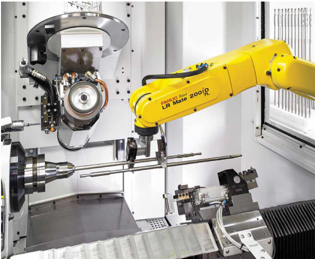
Рисунок 16.18 - Завантаження роботом у поєднанні із зовнішнім палетним магазином
