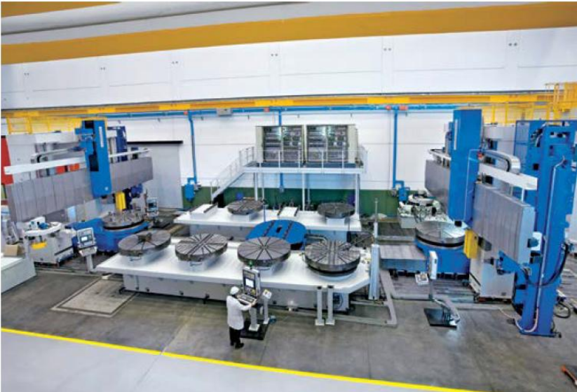
Рисунок 13.8 – Гнучка виробнича система з великих токарних вертикальних верстатів компанії Pietro Carnaghi
