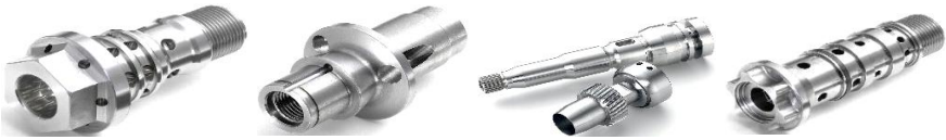
Рисунок 18.9 – Деталі, що оброблюються на верстаті
