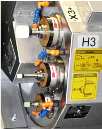
Рисунок 16.9 – Головка для внутрішнього шліфування
