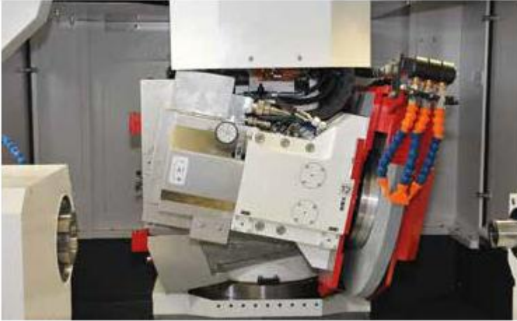
Рисунок 16.2 - Шліфувальна головка з поворотною віссю А
