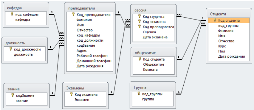
Рисунок 2.1– Схема бази даних Деканат1
