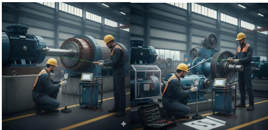
Рисунок 6.7 – Центрування положення валів електродвигуна та робочої машини
