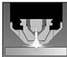
Рисунок 5.8 - Придушення потоку плазмотворчого газу
