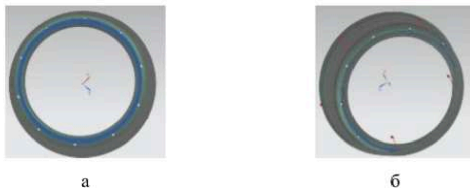
Рисунок 4.3 – Схема для розрахунку на міцність (а – закріплення; б – прикладання сили)
