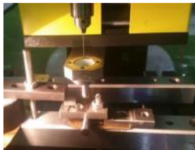
Рисунок 5.1 – Приклад прожигу на верстаті
