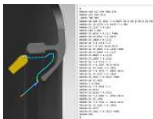
Рисунок 1.24 – Траєкторія руху інструменту та УП на операцію 040 перехід 3
