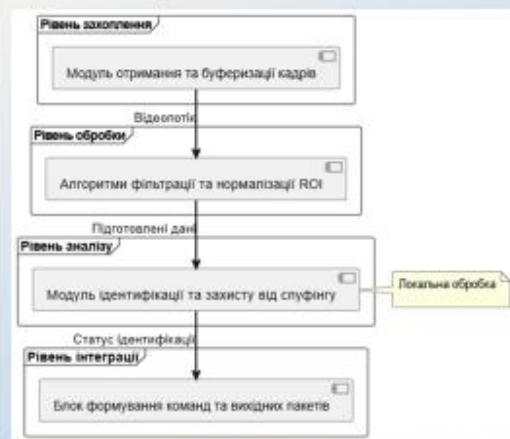
Схема модульної архітектури інтелектуальної підсистеми
