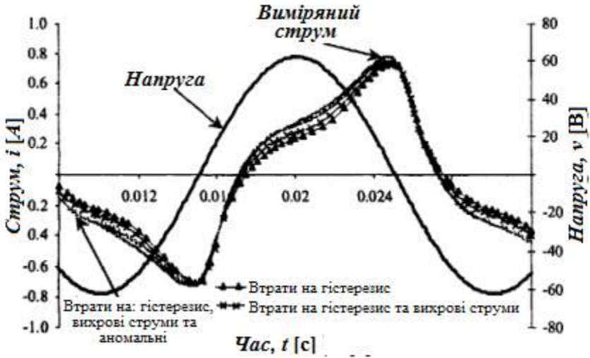
Рисунок 10.5 – Виміряні і розраховані форми кривої струму при 50 Гц
