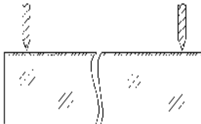
Рисунок 8.2 – Схематичне зображення зондів для вимірювання опору.
