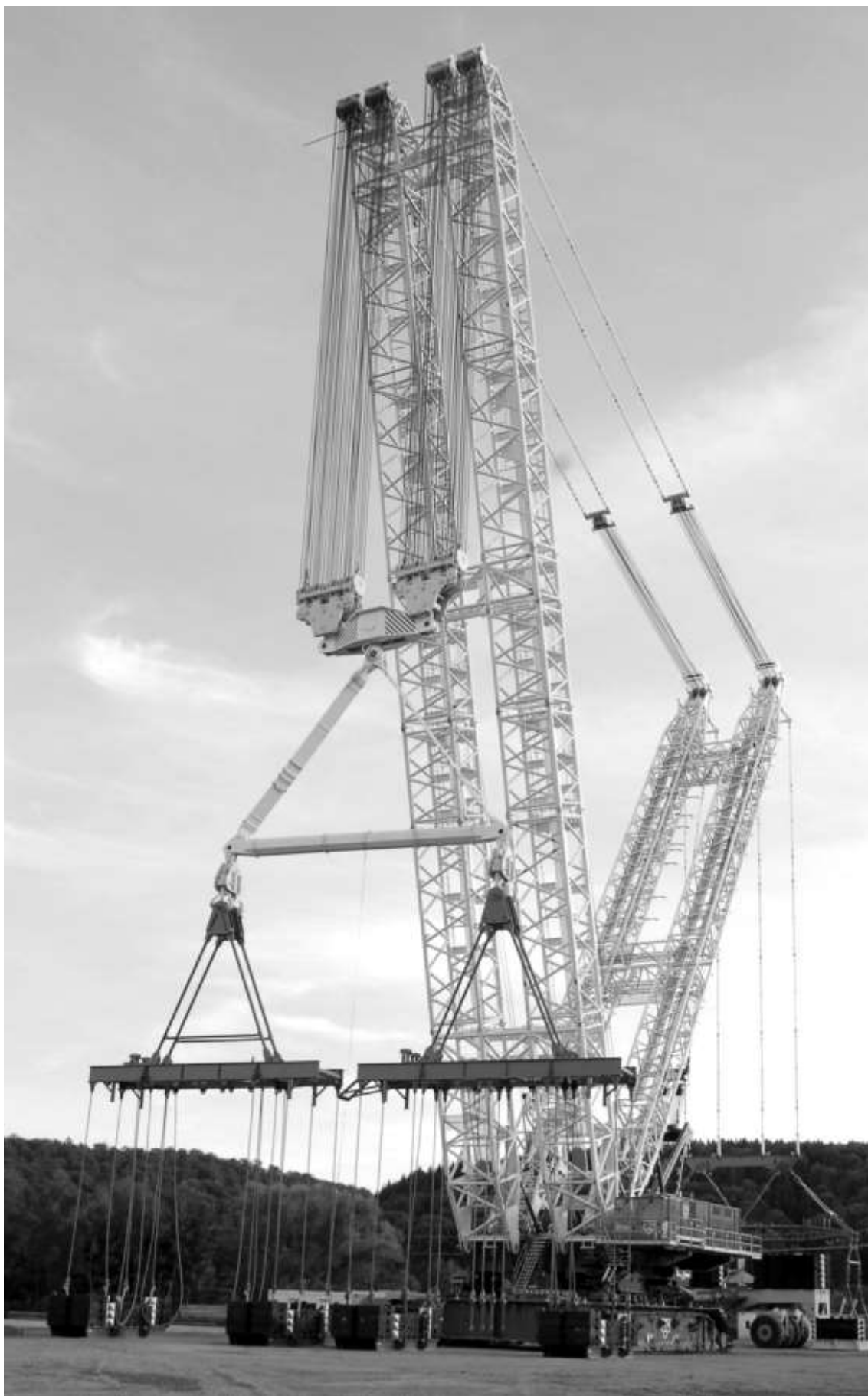
Рисунок 1.7 – Кран XCMG XGC88000 зі спеціальною балансирною системою траверз та стропів.
