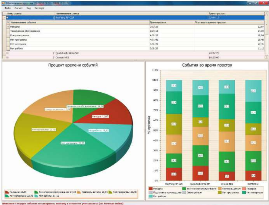
Рисунок 10.75 – Приклад звіту про завантаження обладнання та причини простою
