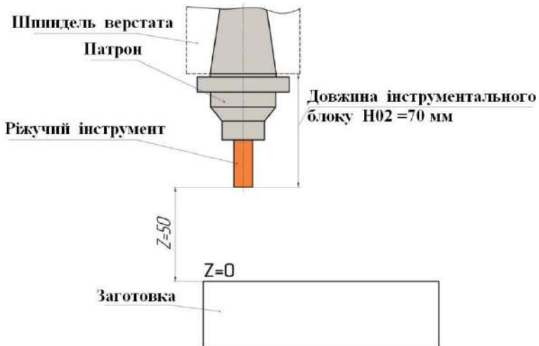
Рисунок 10.35 – Якщо потрібно перемістити інструмент у Z50 і в програмі є код компенсації довжини інструменту, то ріжуча кромка фрези не дійде до поверхні деталі рівно 50 мм
