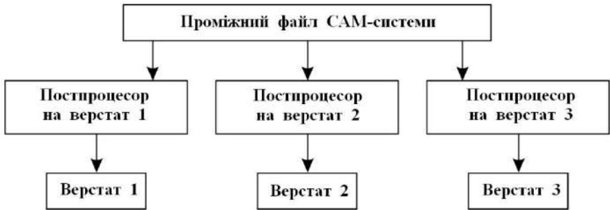
Рисунок 10.63 – Схема створення УП для конкретного комплексу «Верстат – система ЧПУ»
