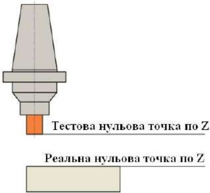
Рисунок 10.24 – Дуже часто перед справжньою обробкою деталі «піднімають» нульову точку по осі Z та УП «проганяють повітрям»
