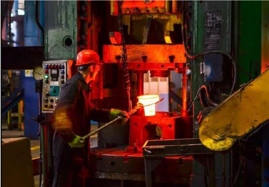
Рисунок 7.1 – Процес гарячого об'ємного штампування
