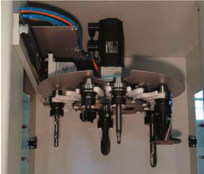
Рисунок 10.32 – Магазин інструментів барабанного типу верстата з ЧПУ
