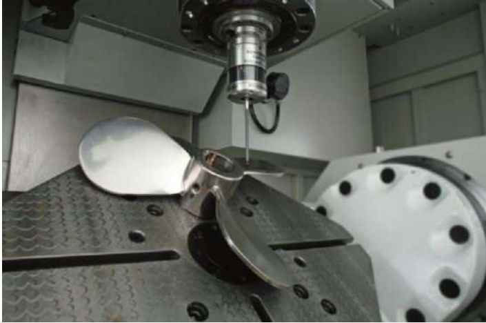
Рисунок 10.73 – Вимірювальний щуп торкається поверхні деталі
