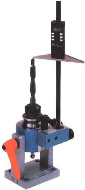
Рисунок 10.72 – Пристрій для вимірювання інструменту поза верстатом
