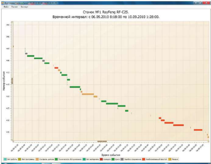
Рисунок 10.77 – Діаграма Ганта подій з конкретним верстатом
