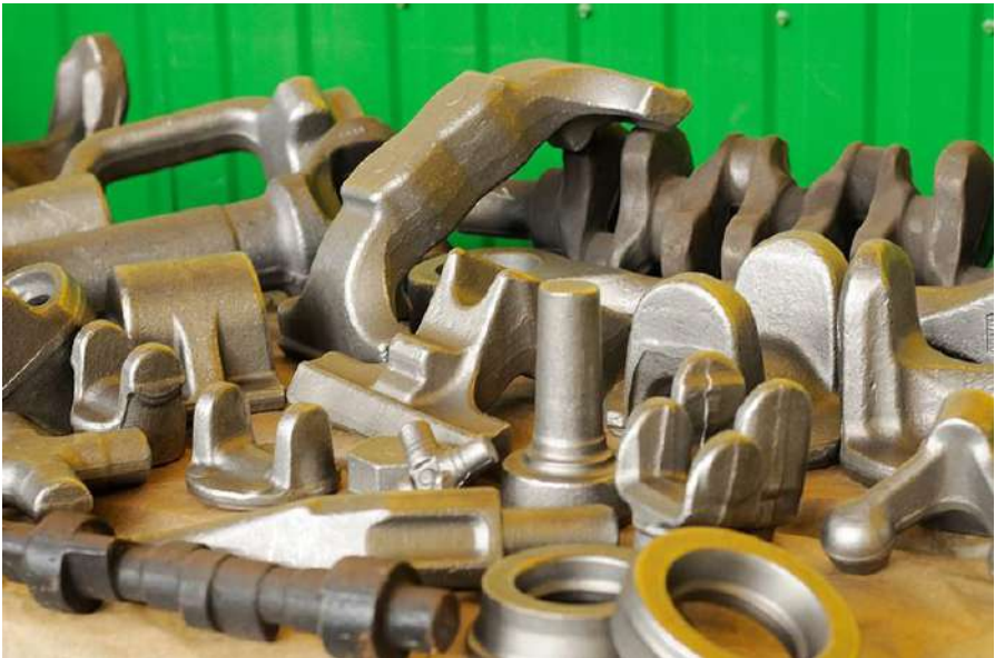
Рисунок 7.2 – Загальний вигляд поковок (заготовки чорнових або проміжних деталей, одержуваних під час кування (пресування) або штампування)
