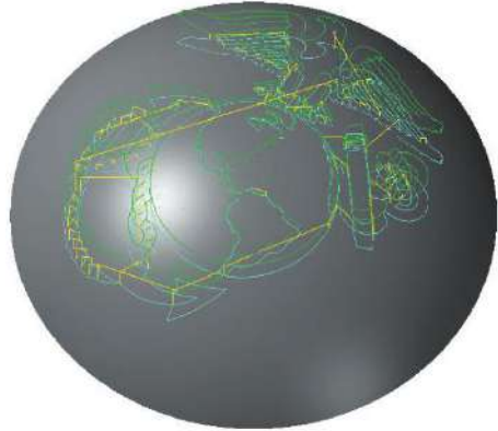
Рисунок 10.60 – Проектування траєкторії на поверхню
