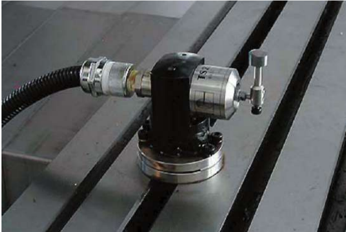
Рисунок 10.71 – Датчик Renishaw TS-27 для вимірювання довжини та радіусу інструменту
