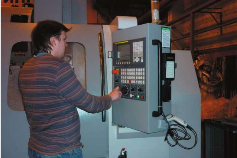
Рисунок 10.74 – Електронний блок моніторингу на верстаті з ЧПУ
