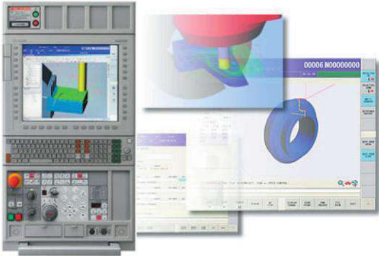
Рисунок 10.6 – Стійка MAPPS IV з CAM-системою ESPRIT
