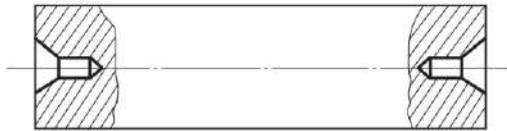
Рисунок 7.19 – Схема розташування центрових отворів
