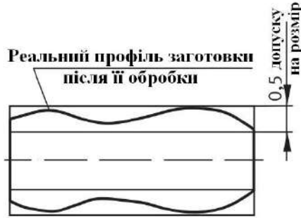
Рисунок 9.11 – Схематичне зображення конфігурації заготовки після токарної обробки на фіксованих режимах різання
