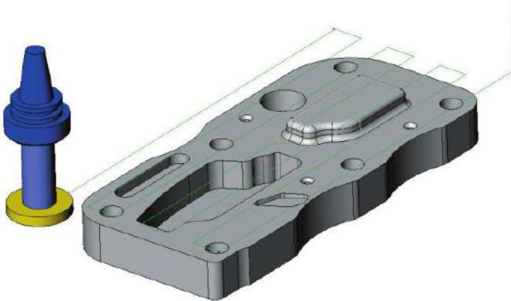
Рисунок 10.50 – Обробка кишені (Pocket): вибірка замкнутих областей; основними параметрами є крок між проходами фрези і тип траєкторії (паралельна, спіральна, зигзаги тощо)
