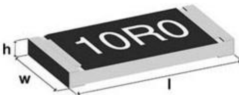
Рисунок 6.3 - Зовнішній вигляд резистора SMD
