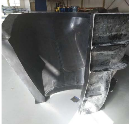
Рисунок 1 - Композиційне оснащення кабіни вертольота
