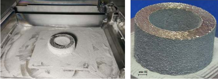
Рисунок 1. – Зовнішній вигляд виробу отриманого методом 3D друку із титанових порошкових матеріалів із несферичною формою частинок
