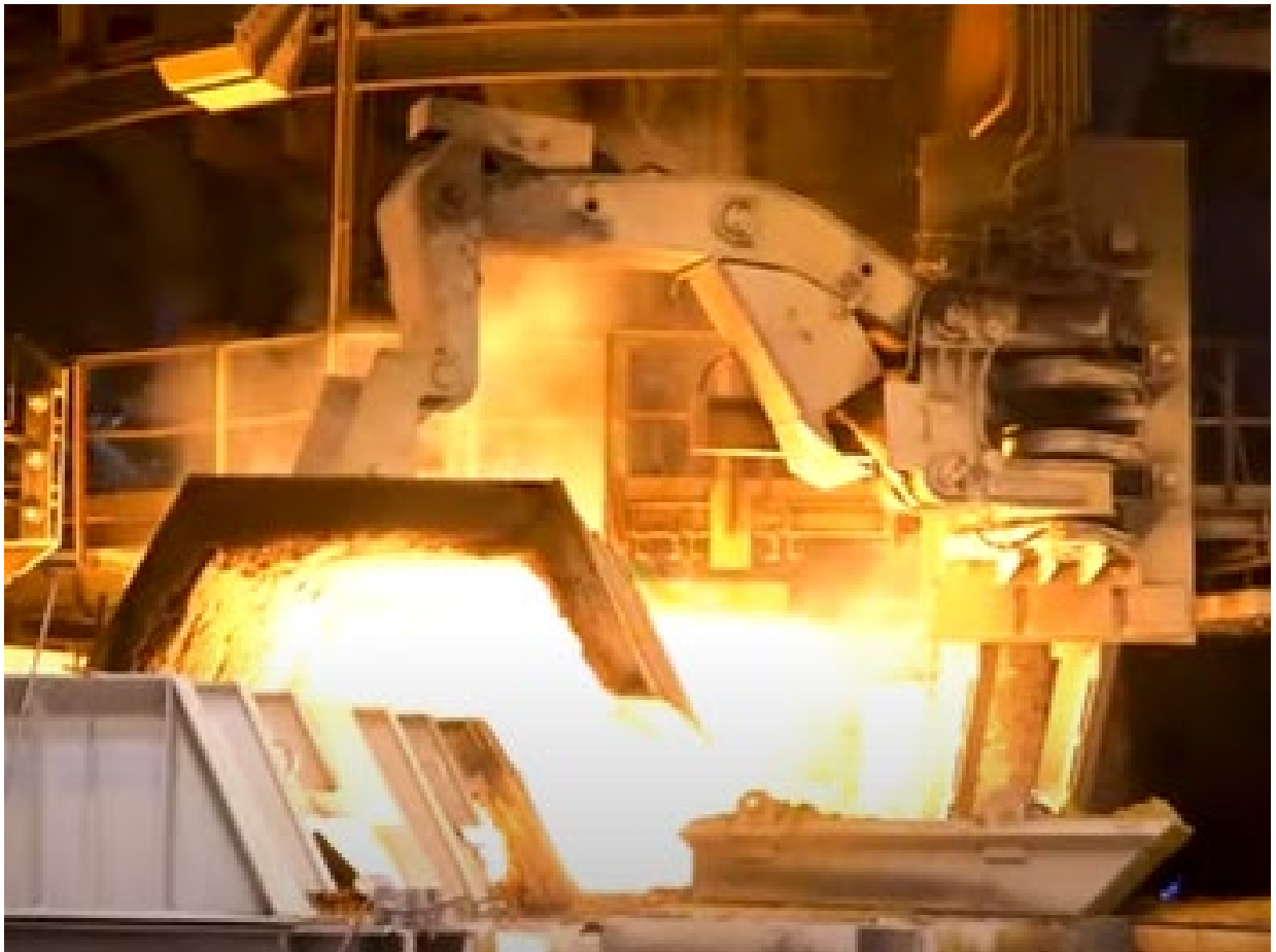
Рисунок 1.4 – Ливарний двір сучасної доменної печі
