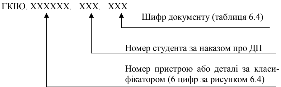
Рисунок 6.3 – Схема позначення креслень
