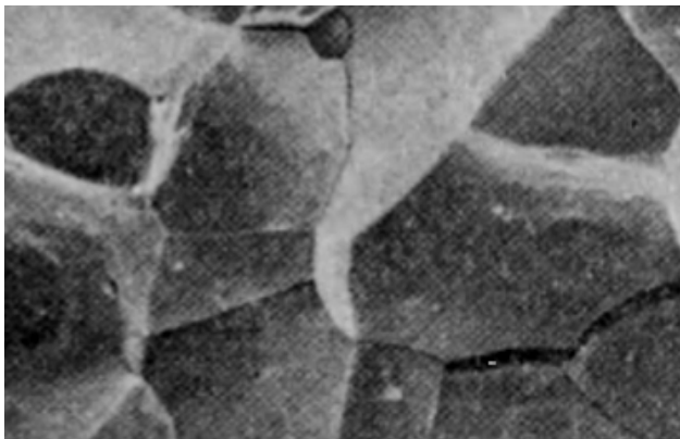
Рисунок 3.11 – Мікрофрактограма міжзеренного крихкого руйнування (РЕМ), \times 1060
