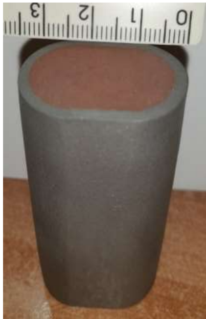
Рисунок 4.2 – Макроструктура на торці темплету
