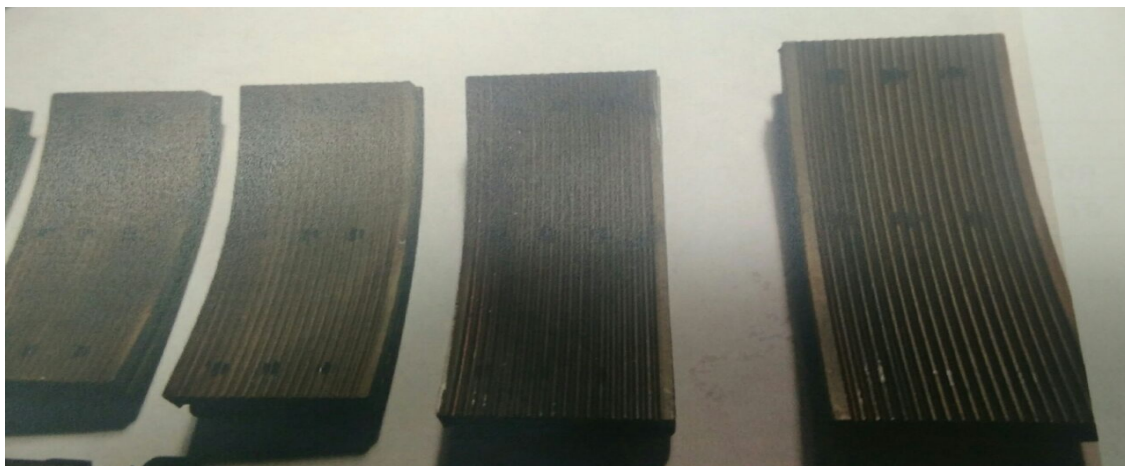
Рисунок 2.7 – Проставки СА ТК з покриттям М-427.25 (з нарізаними канавками) після роботи [24]
