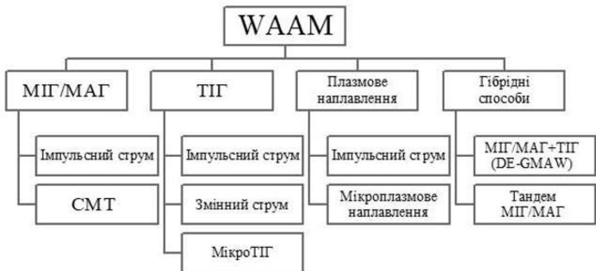
Рисунок 1.11 – Способи дугового наплавлення, що застосовуються для WAAM
