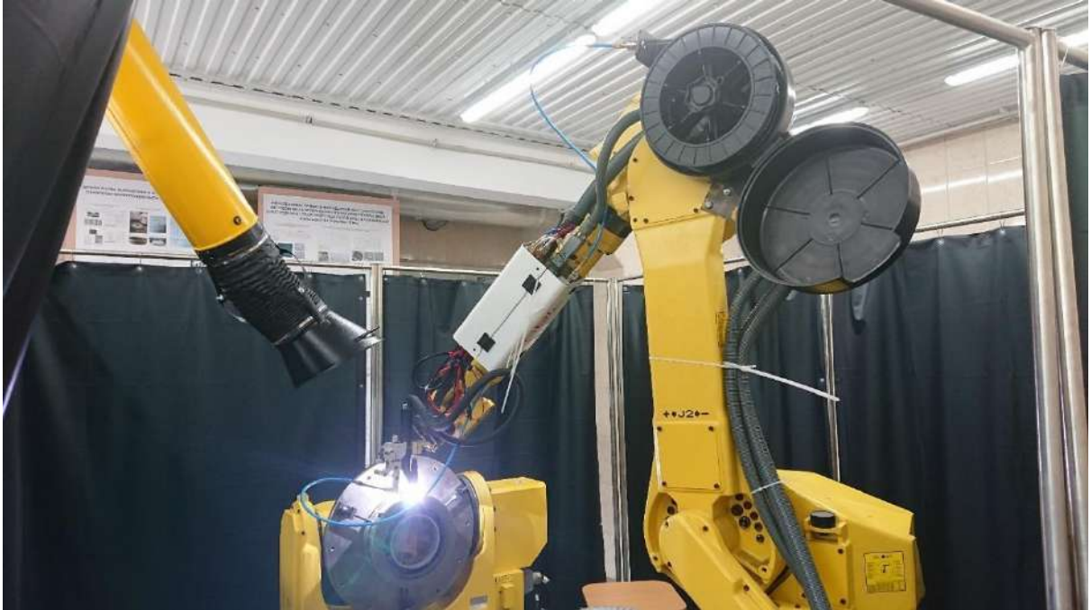
Рисунок 3.16 – Установка для прямого вирощування методом плазмового наплавлення
