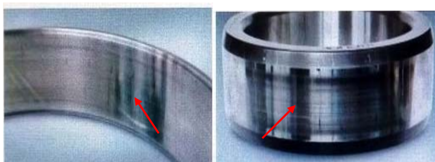
Рисунок 6.12 – Пошкодження при складанні [13]
