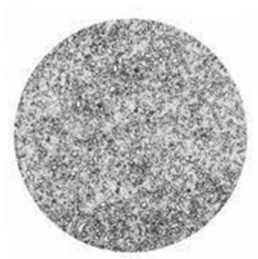
Рисунок 4.4 – Структура сталі ШХ15 після термічної обробки, \times 500 [3]
