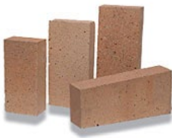
Рисунок 1.13 - Вироби вогнетривкі шамотні для насадки регенераторів мартенівських печей.
