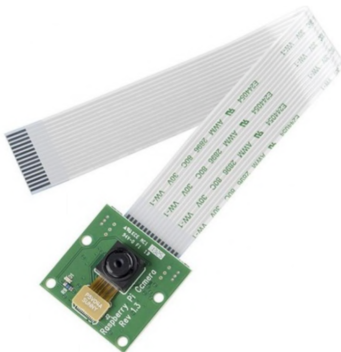
Рисунок 2.6 – Підключення кабелю до камери.
