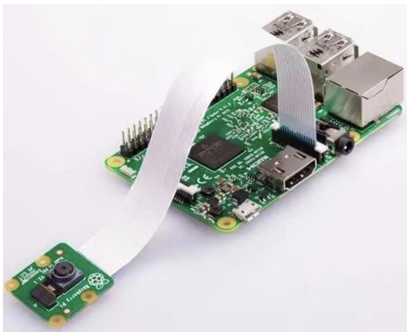
Рисунок 2.8 - Підключення модуля камери до Raspberry Pi
