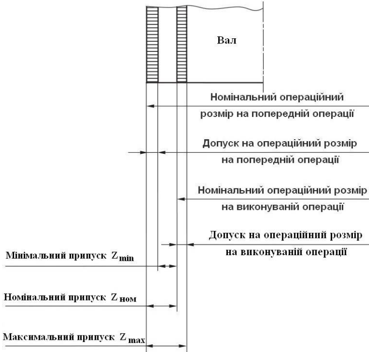
Рисунок 5.5 – Схема розташування операційних припусків і допусків під час обробки зовнішньої циліндричної поверхні (вала)
