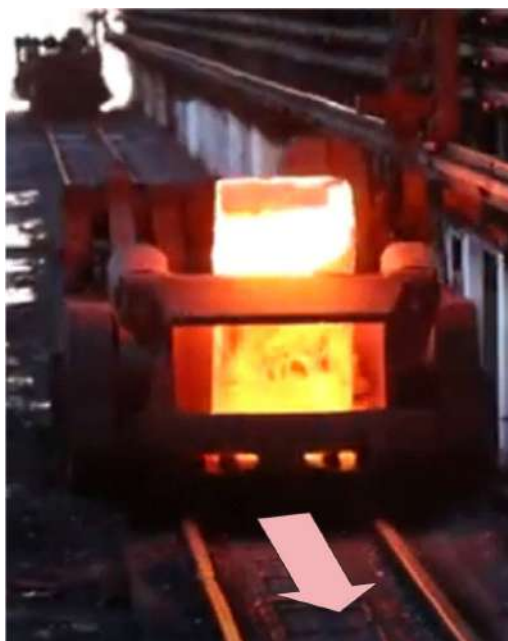
Рисунок 1.10 – Доставка злитків по рейках
