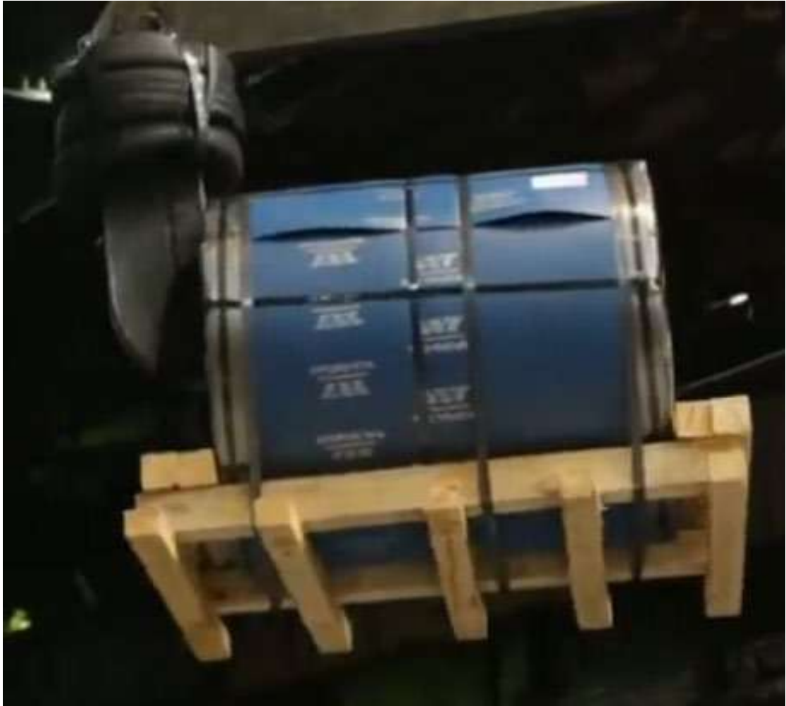
Рисунок 1.16 – Спеціалізовані вантажозаплювальні пристрої для переміщення рулонів прокату
