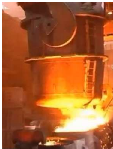
Рисунок 1.6 – Розливання чавуну по складах виливниць
