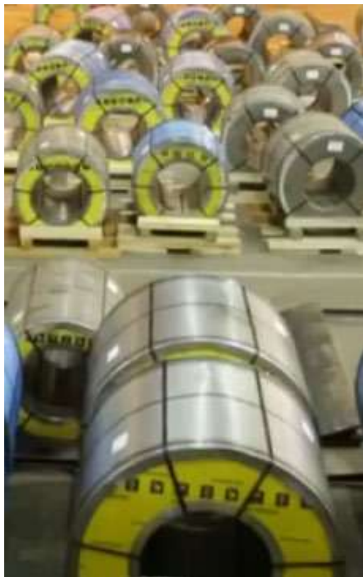
Рисунок 1.14 – Розміщення на складі прокату у рулонах
