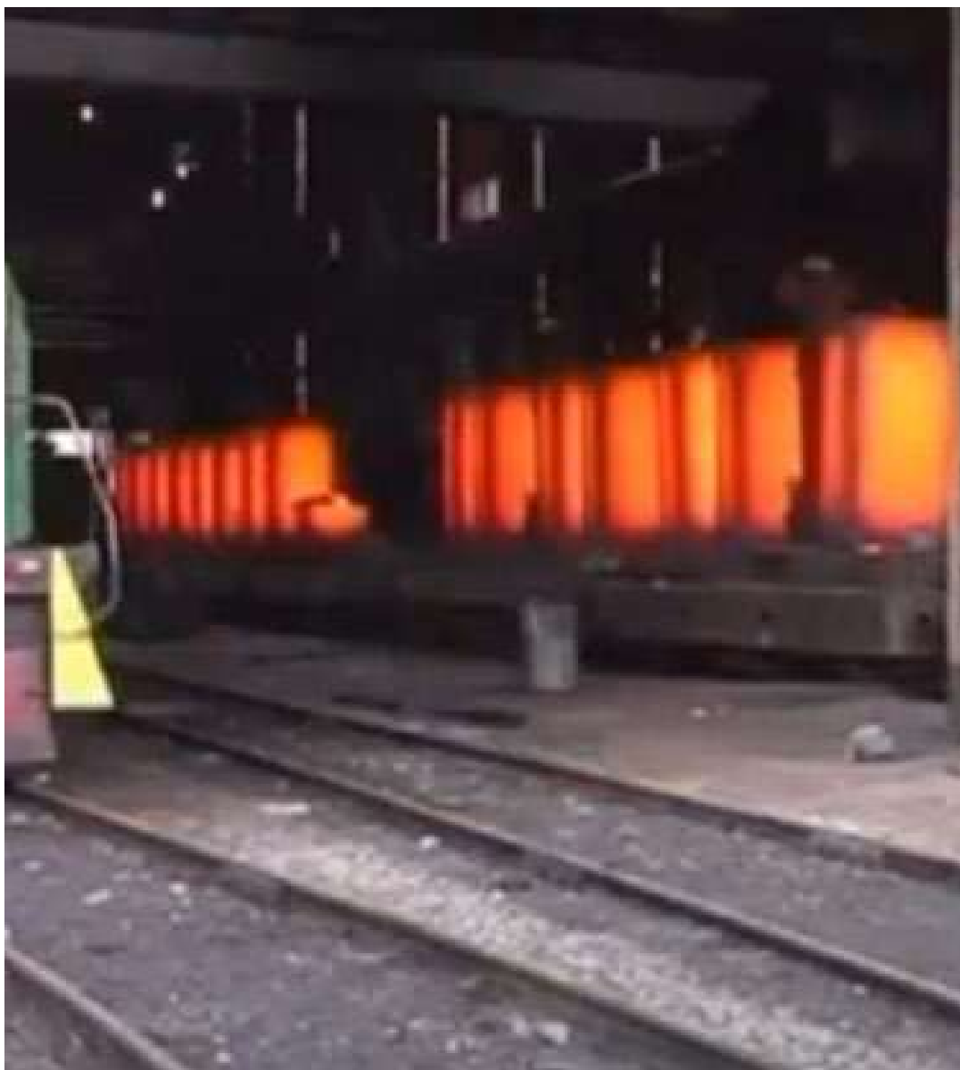
Рисунок 1.7 - Охолодження виливниць та роздягання злитків
