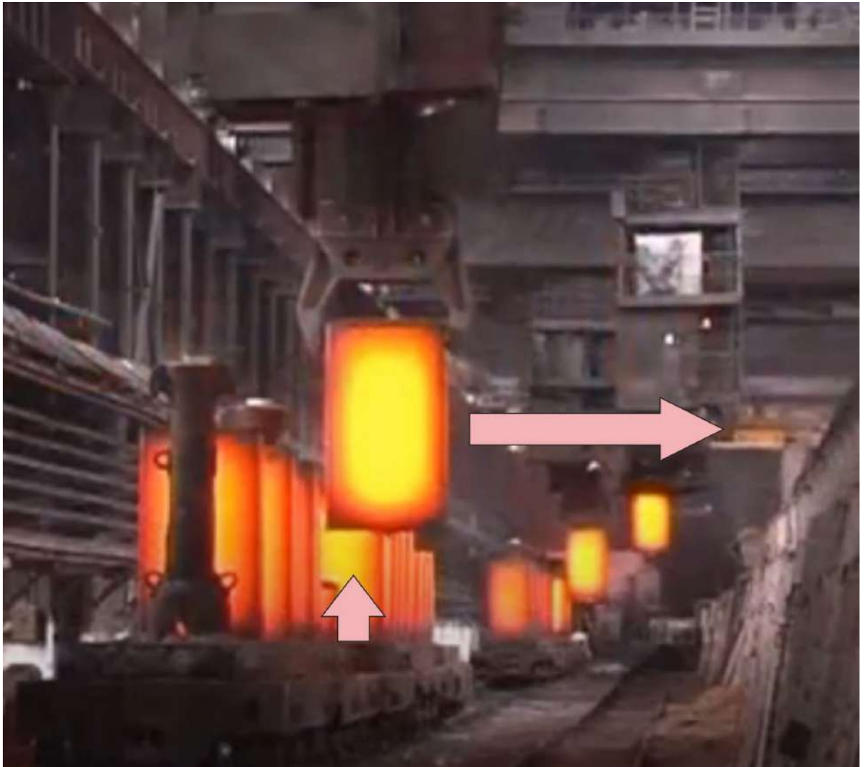
Рисунок 1.8 – Переміщення злитків кліщовими захоплювачами мостових кранів до нагрівальних колодязів
