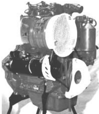
Рисунок Б.7 – Двигун Д120: чотирьохтактний, рядний, двоциліндровий дизельний двигун повітряного охолодження
