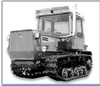
Рисунок А.4 – Трактор ХТЗ-181, двигун 238КМ2-3 (ТОВ «Автодизель», Росія)
