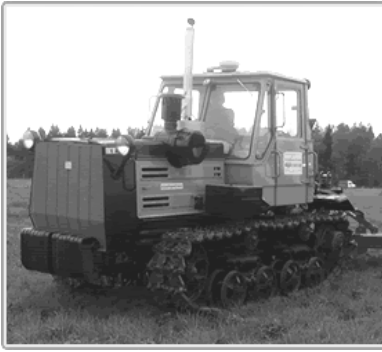
Рисунок А.3 – Трактор Т-150-05-09, двигун ЯМЗ-236Д-3 (ТОВ «Автодизель», Росія)
