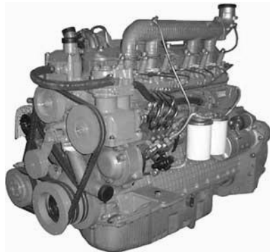
Рисунок Б.4 – Двигун Д-260.7С: шестициліндровий, рядний, чотирьохтактний дизель, рідинного охолодження, з газотурбінним наддувом і проміжним охолодження наддувочного повітря
