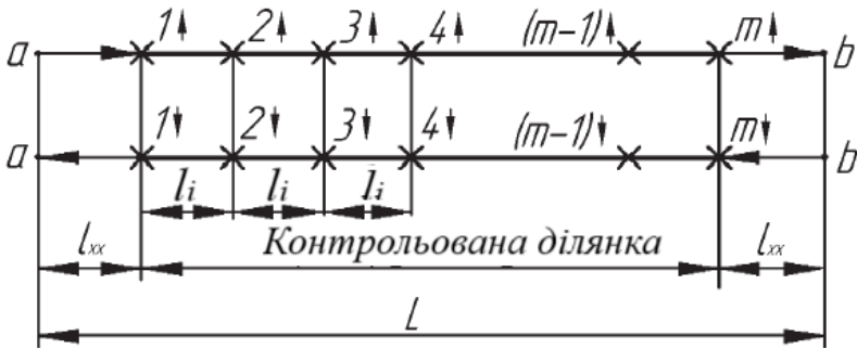
Рисунок 11.1 – Схема переміщення рухомого вузла для визначення точності позиціонування
