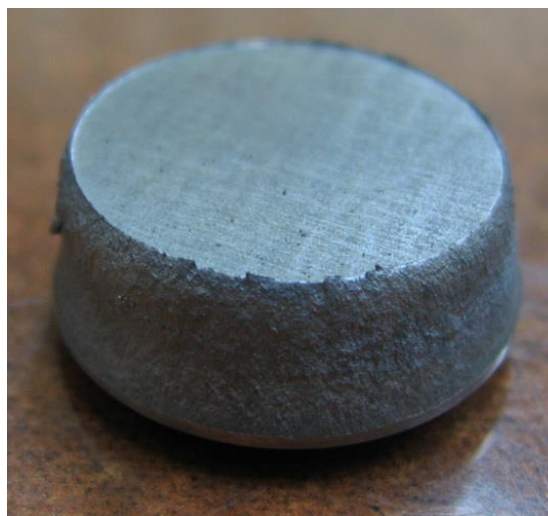
Рисунок 1.25 – Фотографія відходу після пробивки
