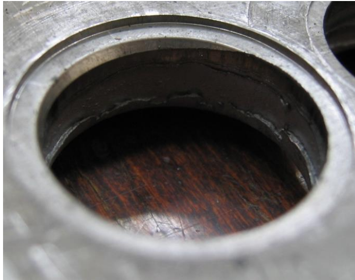
Рисунок 1.21 – Фотокартка пробитого отвору
