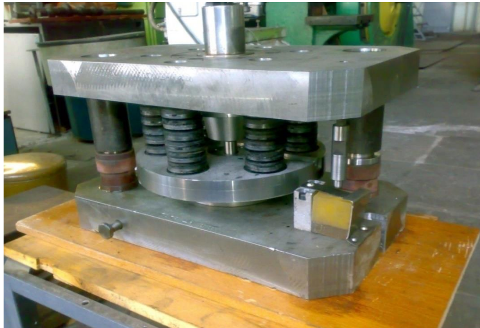
Рисунок 3.2 – Фото експериментального штампа для пробивання отвору
