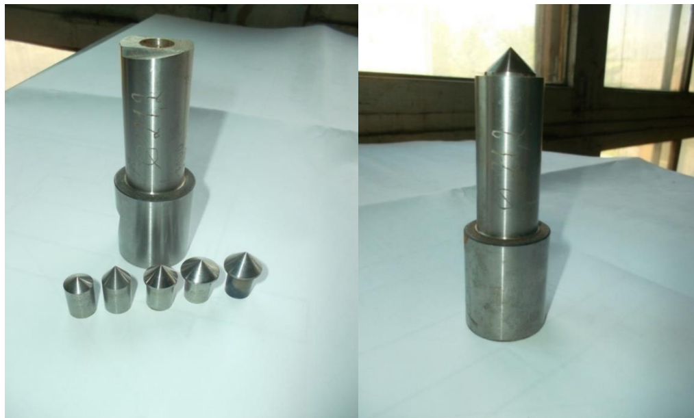
Рисунок 3.5 – Пуансон пробивний зі знімними конусними наконечниками.
