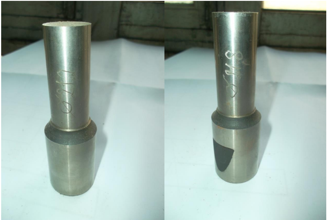
Рисунок 3.7 – Пуансон пробивні з плоскою поверхнею.
