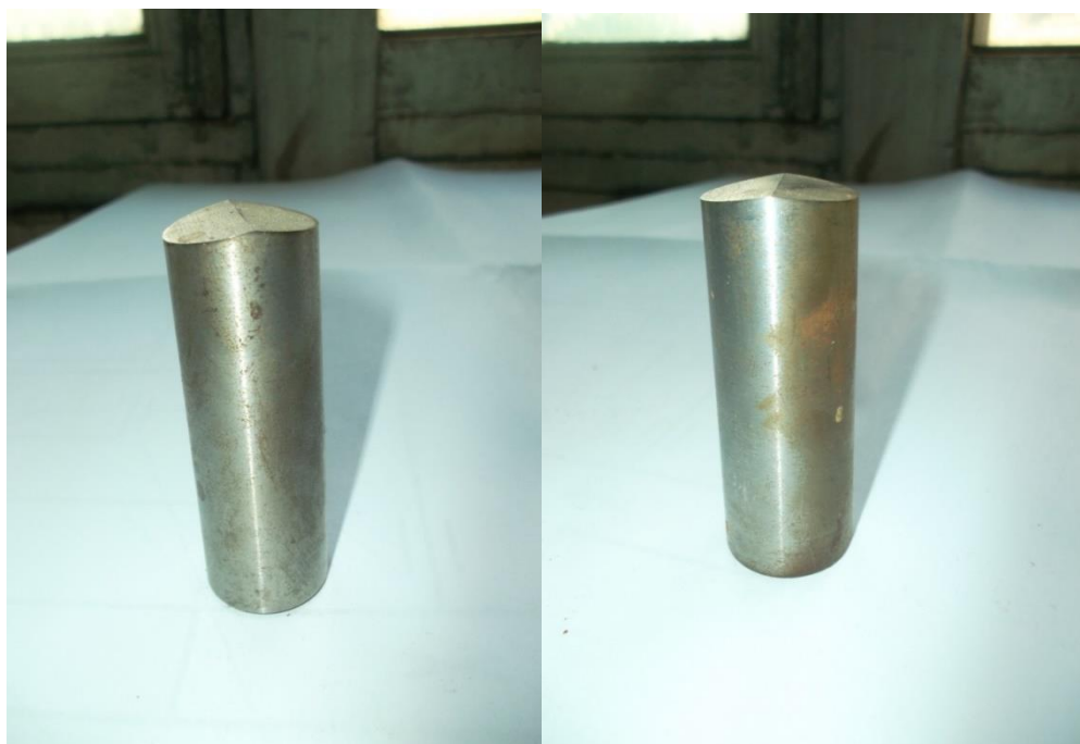
Рисунок 3.6 – Пуансони пробивні в яких скошені поверхні.
