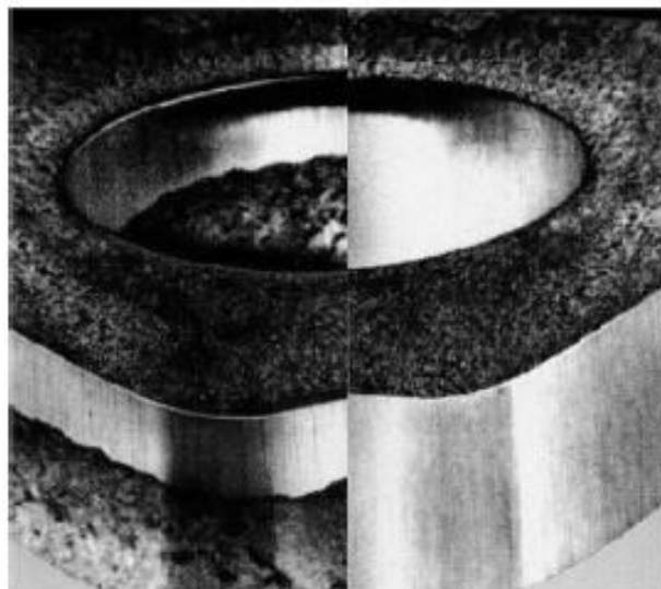
Рисунок 1.33 – Порівняння поверхні звичайної і чистової вирубки-пробивки.
