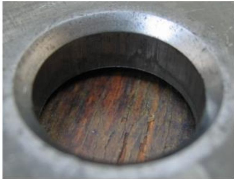
Рисунок 1.29 – Фотографія пробитого отвору з подальшим формуванням фаски
