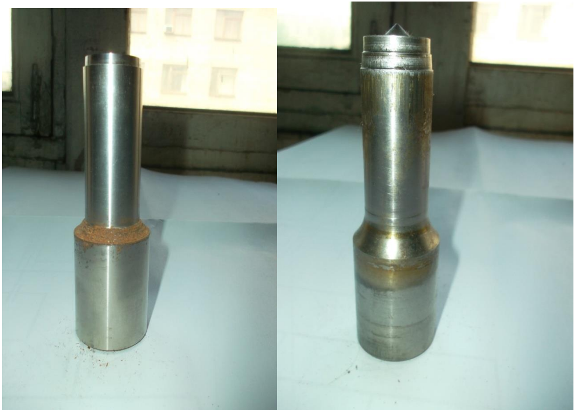
Рисунок 3.8 – Пуансон ступінчастий пробивний (а), пуансон ступінчастий з конусним наконечником (б).
