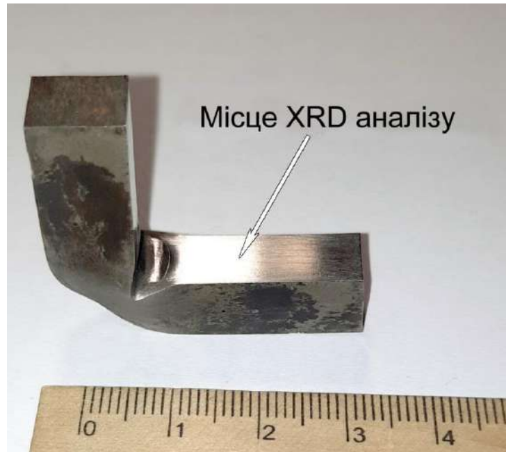
Рис. 3.11. Місце XRD дослідження незруйнованого зразка
