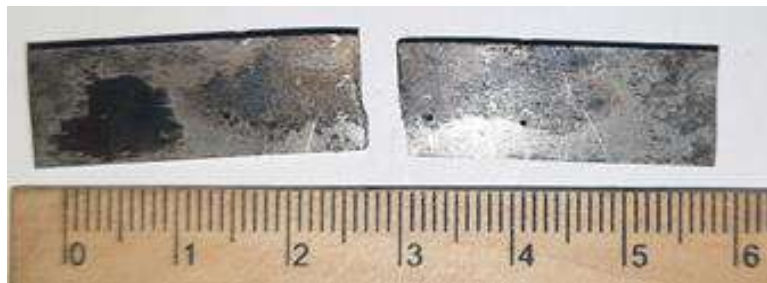
Рис. 3.2. Зразок після термічної обробки з витримкою 8 хвилин та подальшим випробуванням на удар
