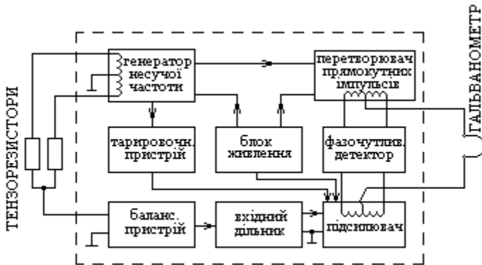
Рисунок 2.5 - Структурна схема каналу тензопідсилювача ТА-5
