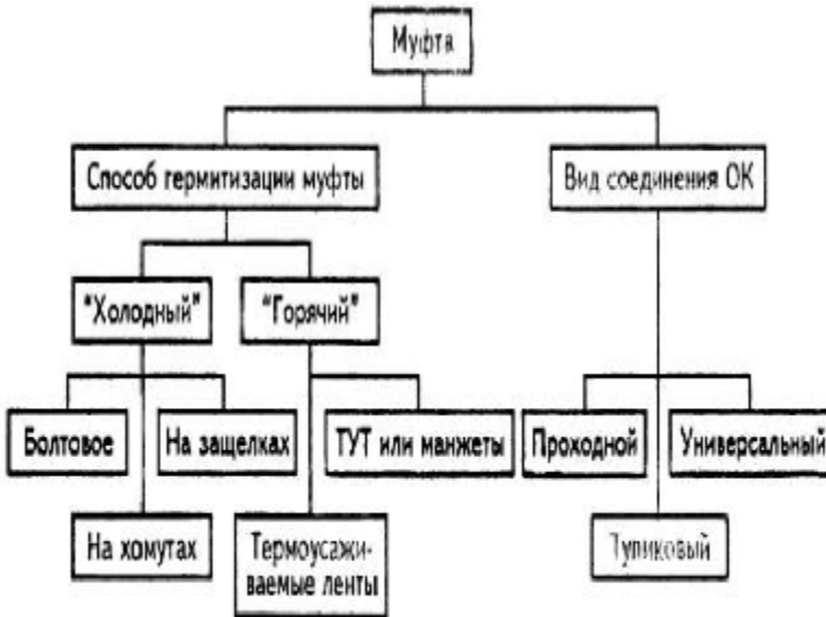
Рисунок 2.1. - Залежність конструкції муфт від способу герметизації і видів з'єднання
