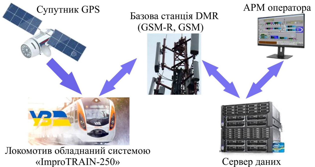
Рисунок 1.5 – Цифровий радіозв'язок в системі локомотивної безпеки «ImproTRAIN-250»
