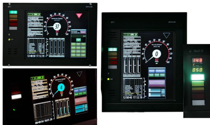
Рисунок 1.2 – Бортова система безпеки «ImproTRAIN-250»: а – розташування у кабіні машиніста, б – інтерфейс системи
