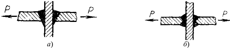
Рисунок 4.19 – Таврові з'єднання виконані АДЗ з повним проваром
