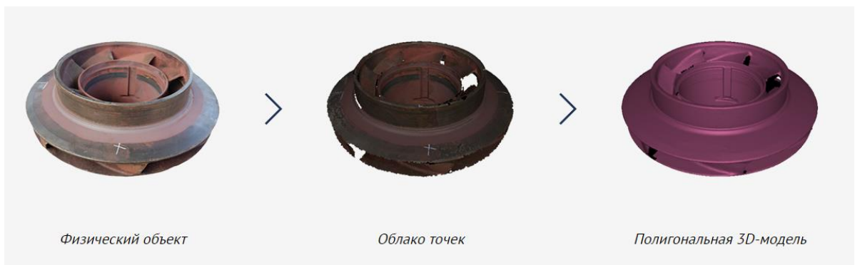
Рисунок 2.2 – Приклад створення полігональної моделі з «хмари точок»
