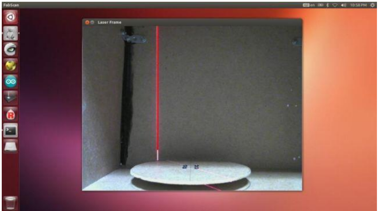
Рисунок 3.9 – Встановлення червоної лінії лазера
