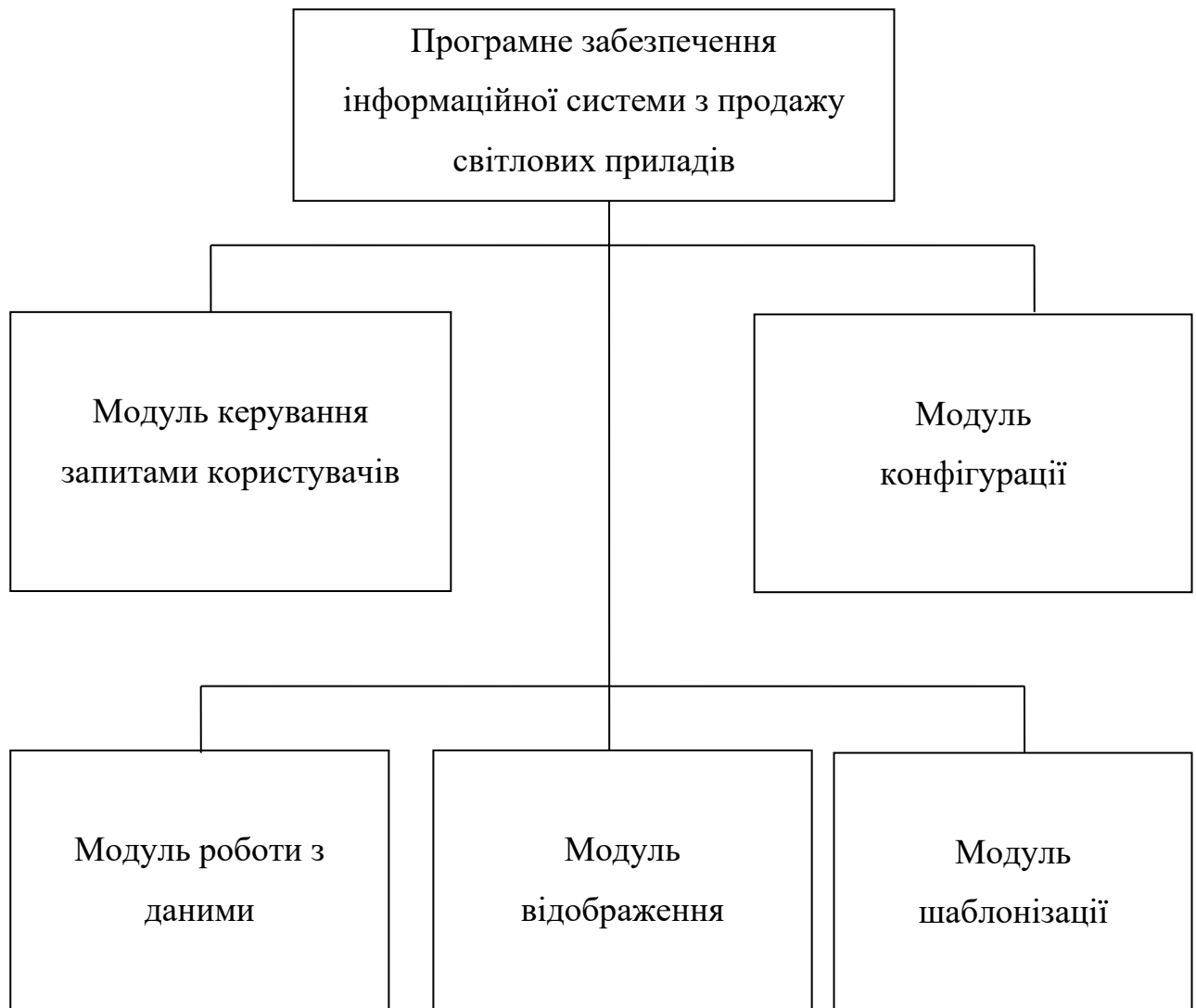
Рисунок 3.1 – Структура програмного забезпечення інформаційної системи з продажу світлових приладів
