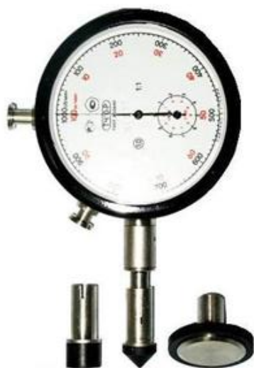
Тахометр годинного типу ТЧ-10Р - для перевірки частоти обертання шпинделя.
