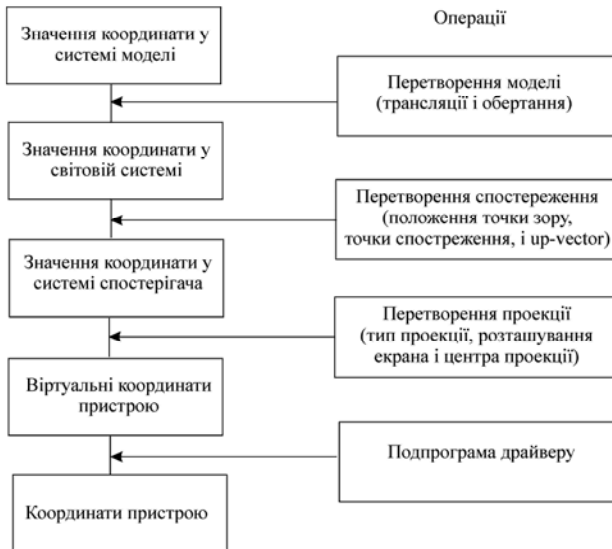
Рисунок 1.5 – Процедура розрахунку точок проєкції з використанням матриць перетворення
