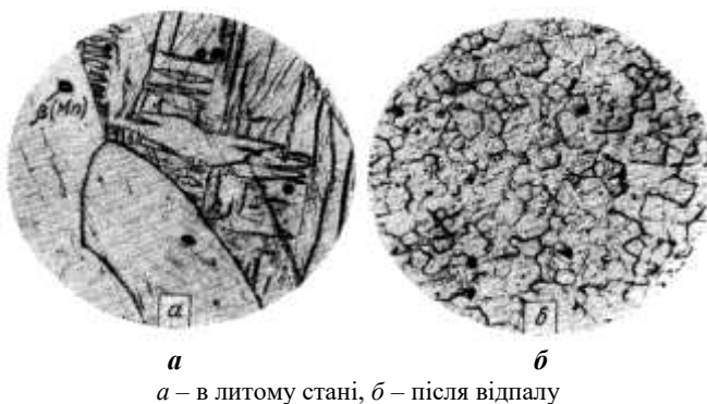
Рисунок 2.1 – Мікроструктура сплаву МА8, \times 200 , [6]
