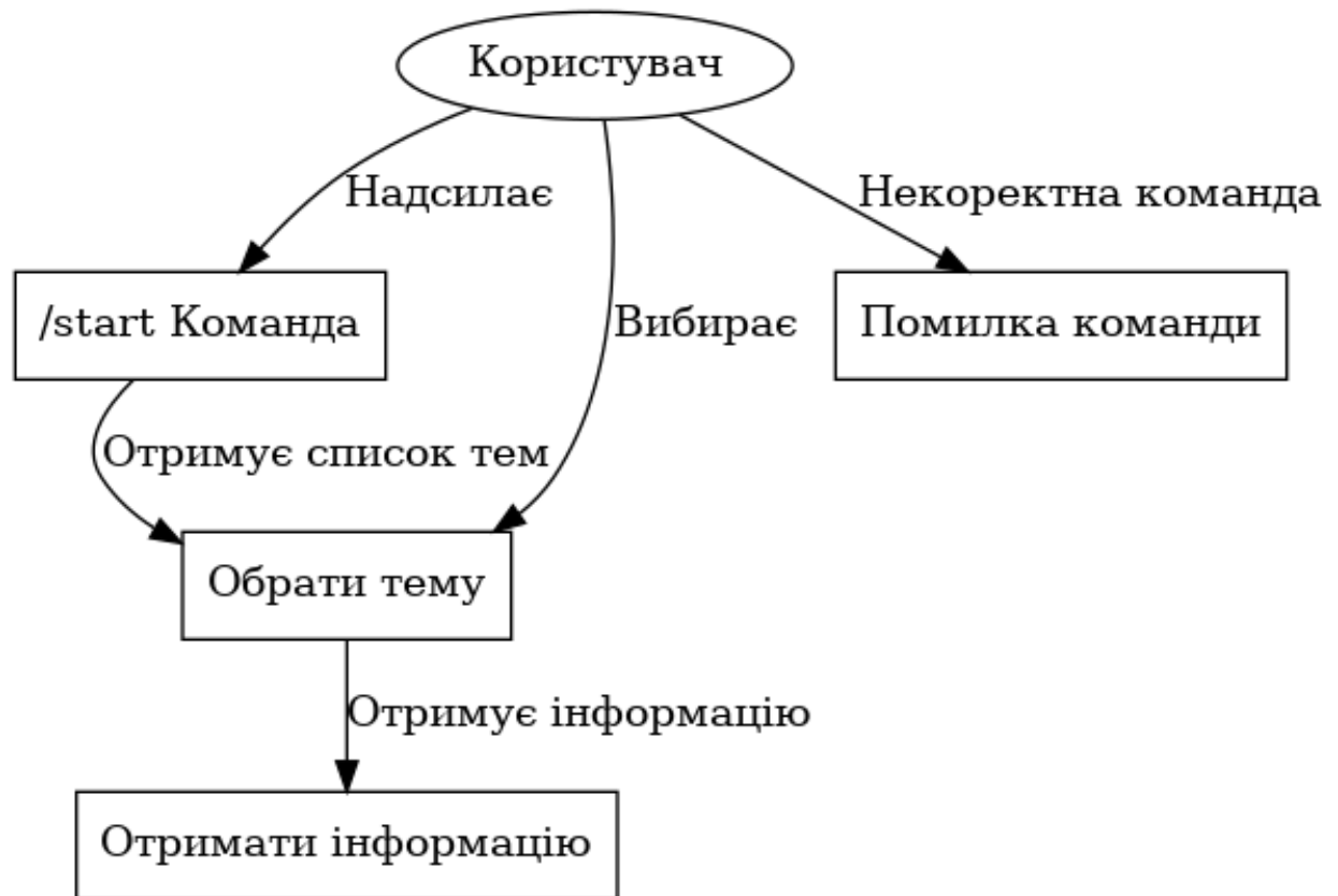
Рисунок 3.4 – Схема варіантів використання
