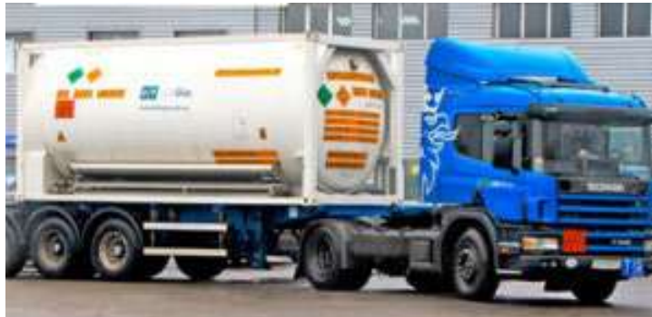
Рисунок 2.1 – Рухомий склад для транспортування аргону охолодженого рідкого
