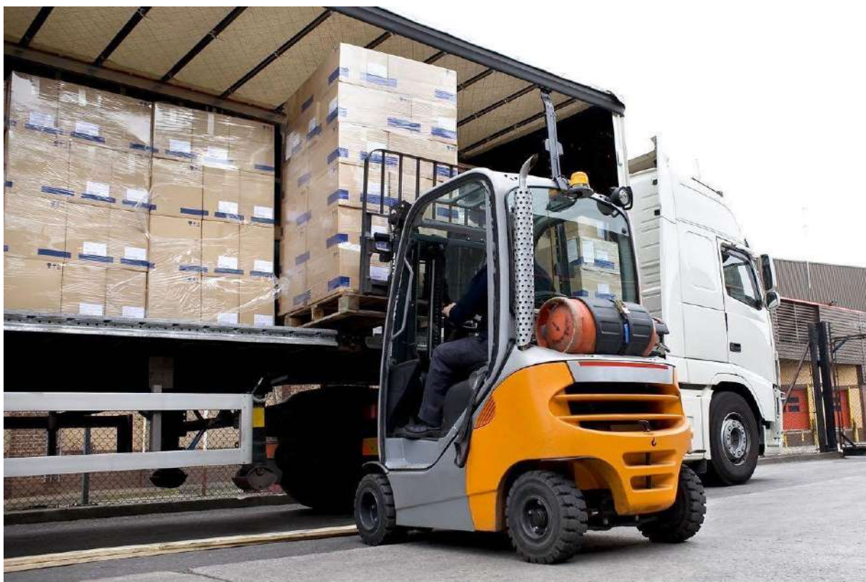
Рисунок 1.3 - Бічне завантаження вантажу з використанням автонавантажувача
