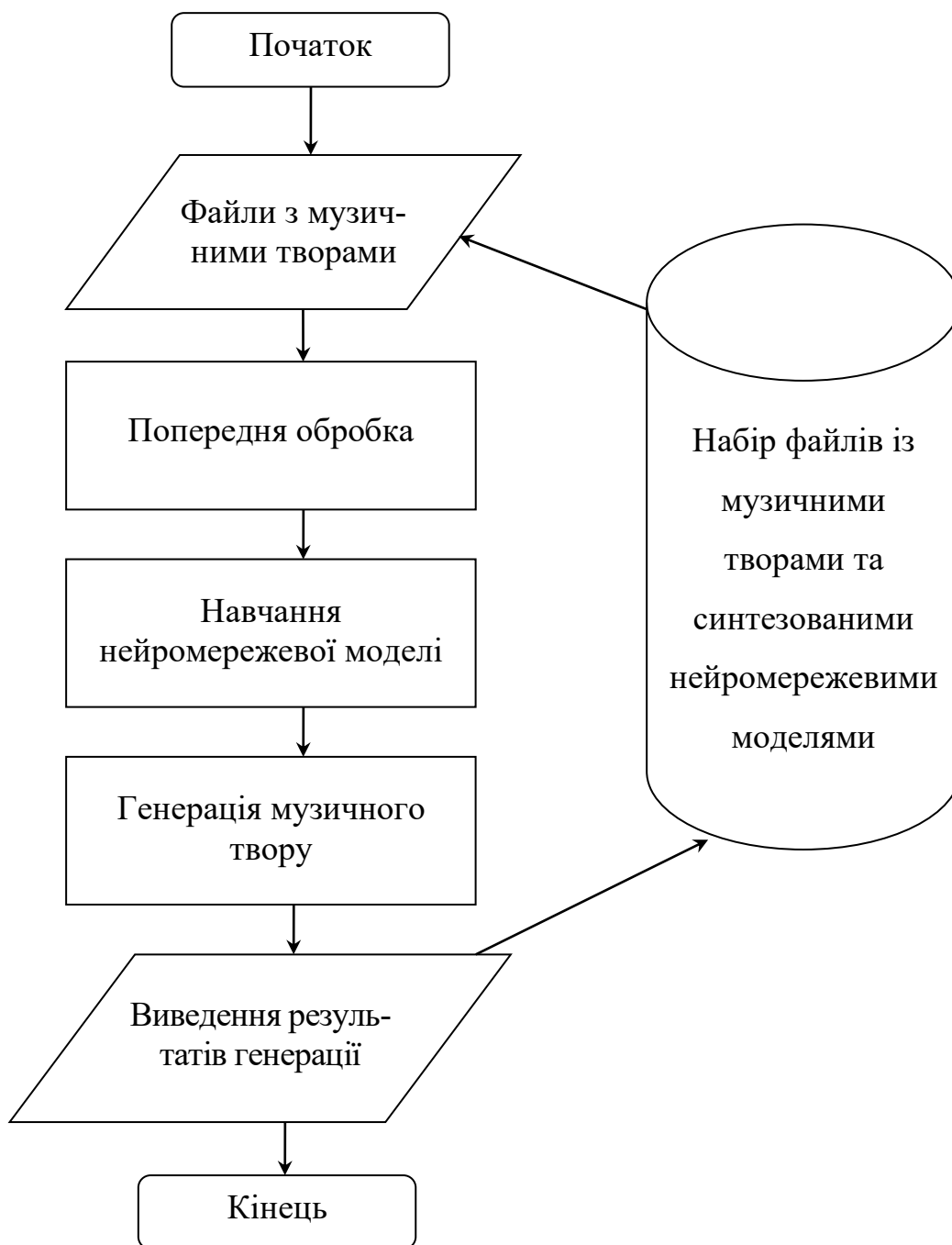
Рисунок 3.2 – Схема функціонування програмного забезпечення інформаційної системи для генерації музичних творів
