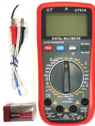
Рисунок 3.4 - Мультиметр UT61A з термопарою TP-01A
