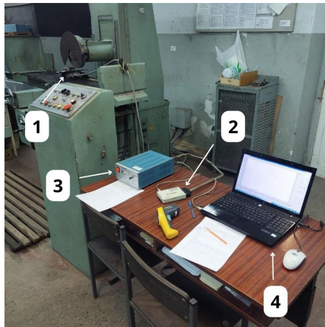
1-динамометр УДМ 300; 2- АЦП; 3-підсилювач; 4- комп'ютер
