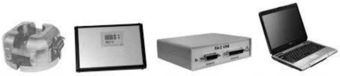
Рисунок 3.7 - Схема вимірювання сили різання
